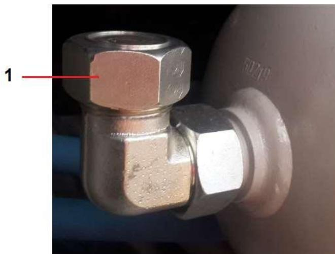
**Рисунок-7** Заправка сепараторного бака маслом (1)
