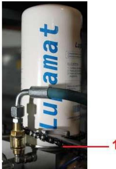
**Рисунок-12** Замена навинчиваемого разделителя
